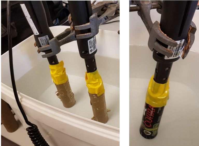
Figuur 1: Links de kartonnen kokers zonder etiket en rechts een lege Cobra 6 met etiket in water. De kokers zijn aan de onderzijde afgesloten met een plastic dopje. De luchtvochtigheidsmeter bevindt zich in de koker en aan de bovenzijde is de koker afgesloten met tape. De luchtvochtigheid, gemeten met de luchtvochtigheidsmeter, is in de volgende grafiek weergegeven.
