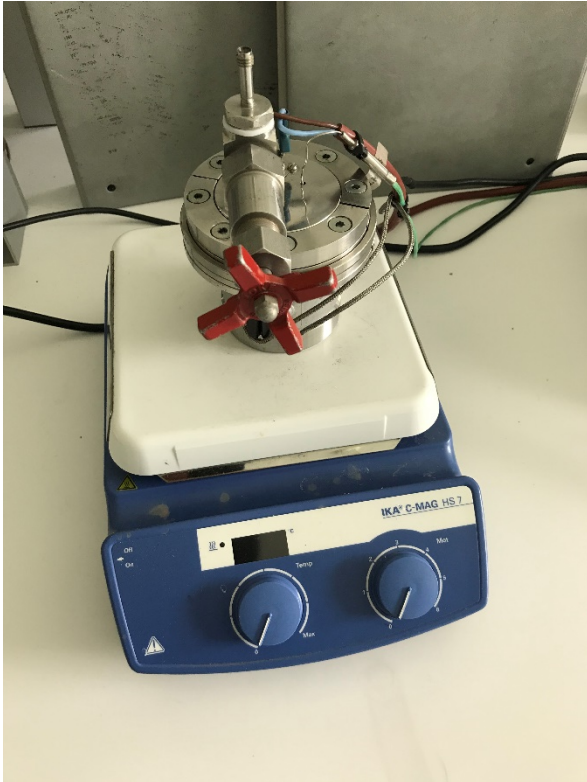
Figuur 2 Het Hastelloy-C vaatje inclusief temperatuurregeling. De leidingen om gasmonsters te nemen ter bepaling van de samenstelling met een gaschromatograaf zijn gedeeltelijk zichtbaar.
