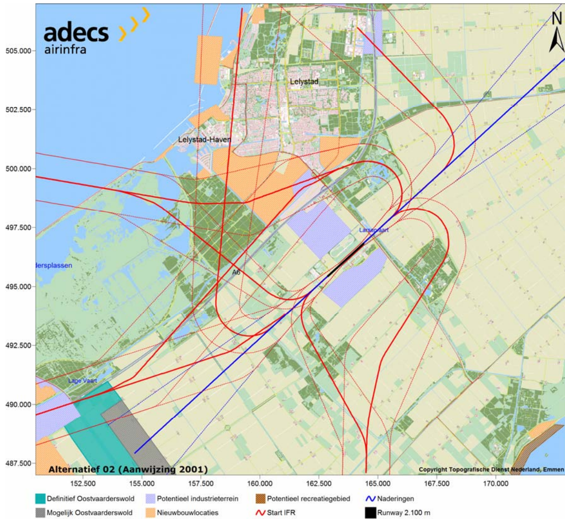
Figuur 8 Routestructuur behorende bij het referentiealternatief (Aanwijzing 2001), alleen voor het IFR verkeer, met middels stippellijn aangegeven spreidingsgebieden.
